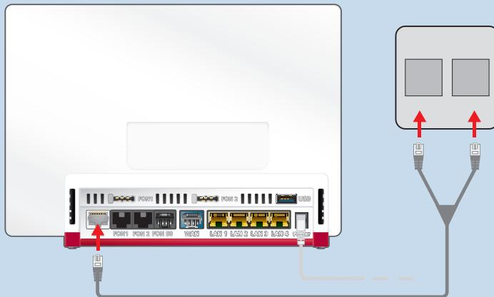
2. Stecken Sie die kurzen Kabelenden in die zwei Buchsen an der Telefondose.
