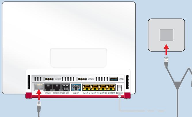
2. Stecken Sie eines der kurzen Kabelenden in die Telefondose. An der FRITZ!Box leuchtet nach kurzer Zeit die LED „Power“.
